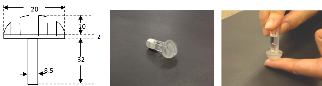
図表 4-7 触覚溝刺激の寸法・単位 mm（左）と刺激の仕方（右）
