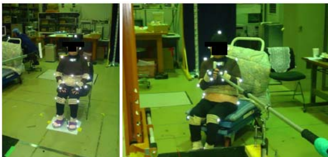
図表 2-4 マーカの取り付け状態と計測動作例
