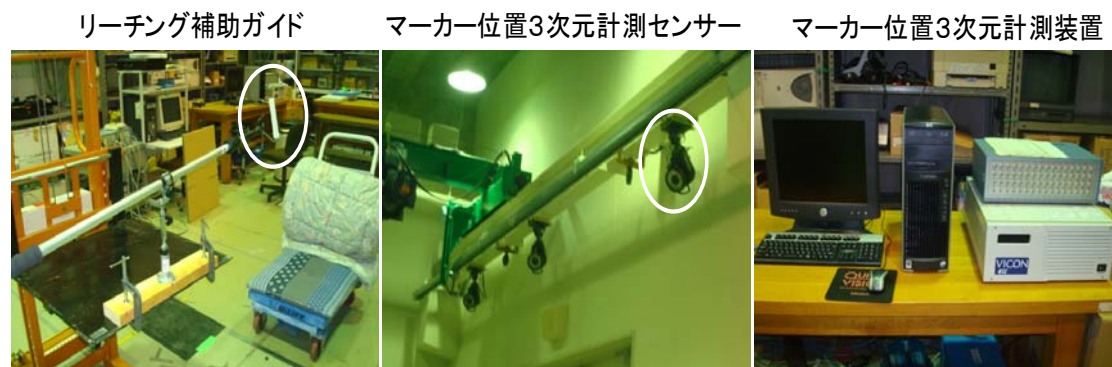
図表 2-3 リーチング動作補助ガイド、三次元動作計測用センサー及び計測装置
