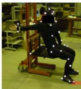
動作計測装置によるリーチング動作の実測
